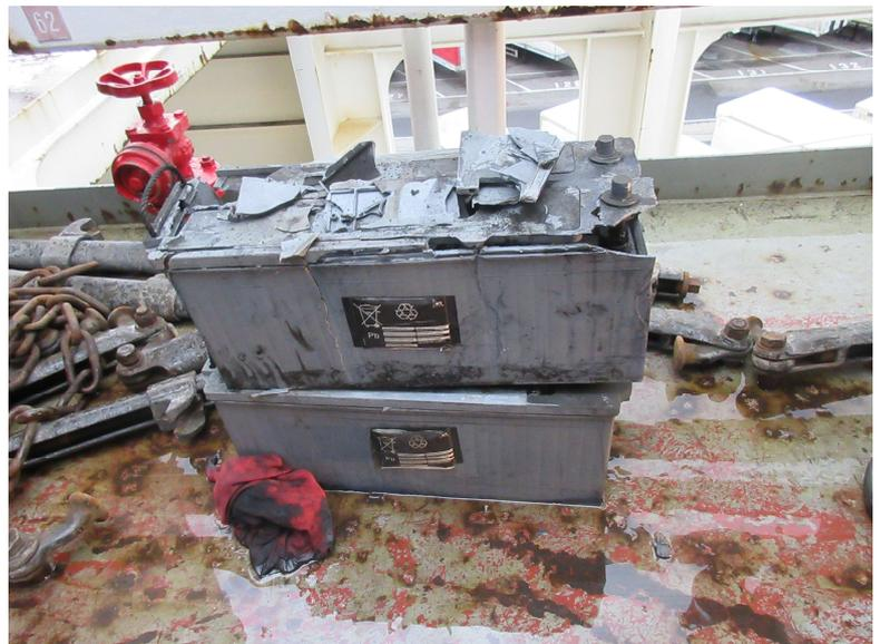
liquidi elettrolitici (di norma acido solforico diluito in acqua distillata variabile dal 33-37%) che reagendo possono generare fumi e vapori corrosivi nocivi per le vie respiratorie dei lavoratori qualora inalati. Per quanto sopra si ritiene utile comunicare la presente *allerta* per informare le ditte che operano nel porto di Trieste di questo specifico rischio e per stimolare l'adozione delle misure di prevenzione più adeguate.
