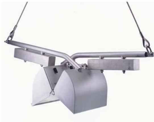
BENNA VAN VEEN PER IL CAMPIONAMENTO DELLE BIOCENOSI DI SUBSTRATO MOLLE.
